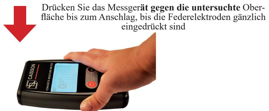
Aufgrund der Tendenz zur einer ungleichmäßigen Feuchtigkeitsverteilung im aushärtenden Beton empfiehlt es sich, mehrere Messungen an dicht aneinander liegenden Stellen vorzunehmen.
